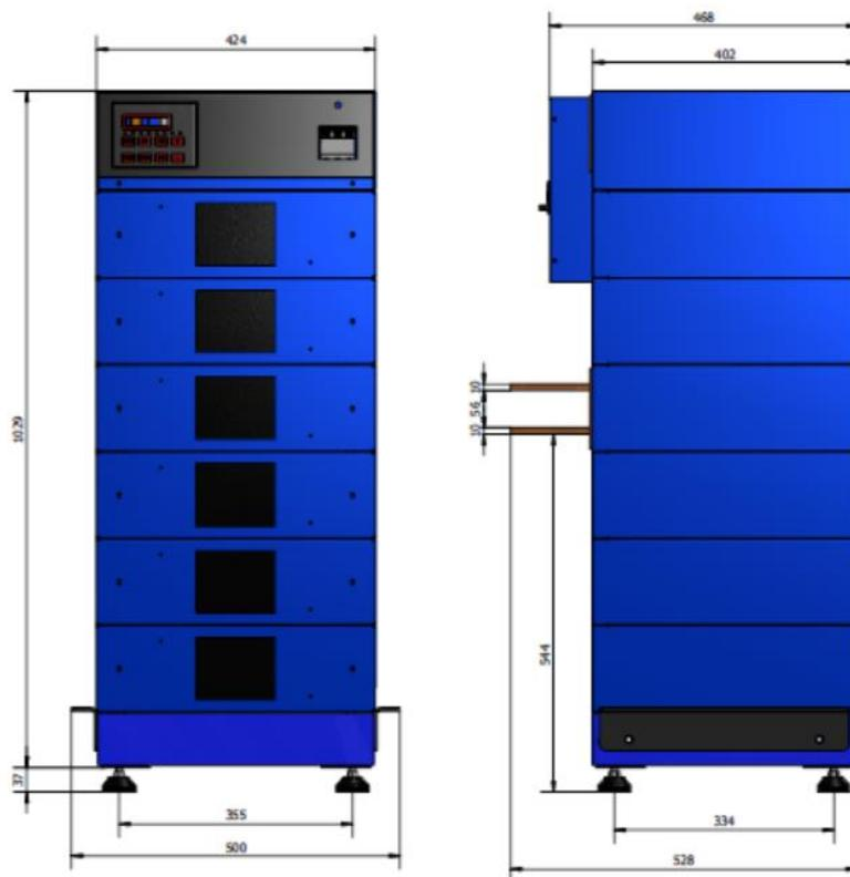
此款整流器采用模块化结构，由直流功率模块与 CPU 板、电源板以及外壳等组件组成，它们之间互相独立而又相互联系，采用 CPU 集中控制，可在主机或遥控器（非标配）上自主设置输出波形参数，也可另外独立配置触摸屏系统（非标配），直观方便操作。可实现软起动（ramp），适合镍，铬，铜，锡，阳极氧化等等多种要求较高的场合及工艺；
